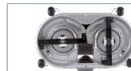
Aufbau des Mähdecks mit synchron-laufenden Messern
