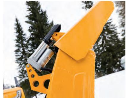
Einer von zwei leistungsstarken, elektrischen Stellmotoren, die für die zielgenaue Wurfweite und -richtung sorgen.
