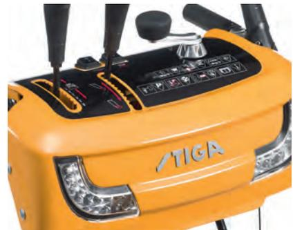
Über das zentrale Bedienpanel werden alle Arbeitsfunktionen der Schneefräse gesteuert. Du hast immer die volle Kontrolle.
